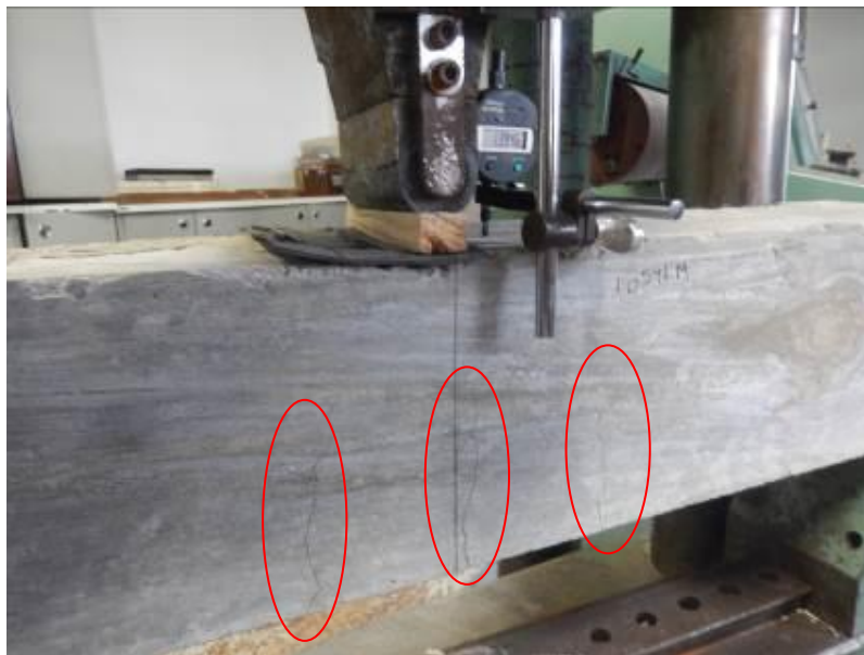
Figura 4 – Fissuras – Carregamento 2800 kgf – Amostra 1.0591.19
