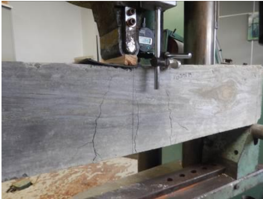
Figura 5 – Fissuras – Carregamento 5600 kgf – Amostra 1.0591.19
