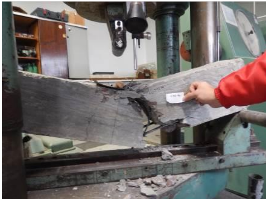
Figura 6 – Ruptura – Carregamento 7100 kgf – Amostra 1.0591.19
