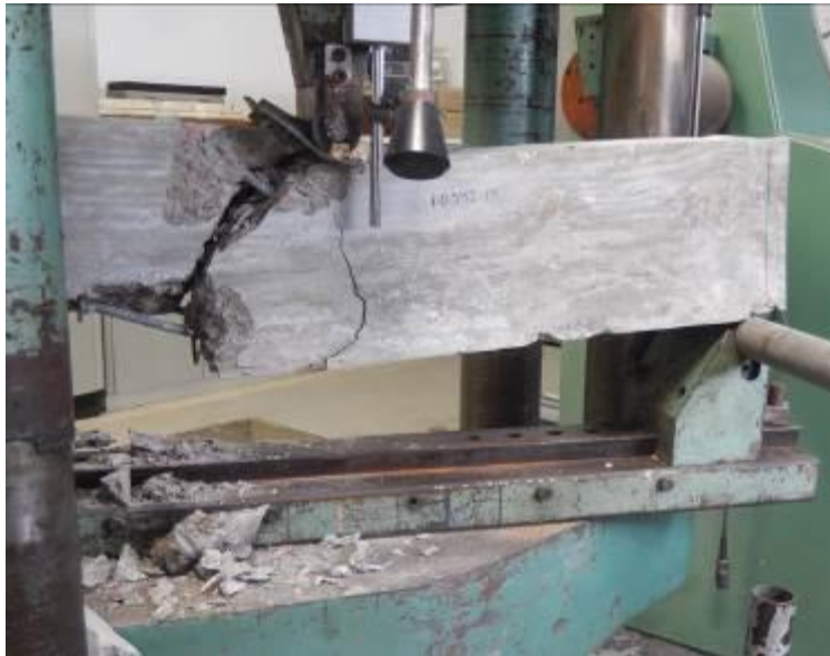
Figura 9 – Ruptura – Carregamento 8250 kgf – Amostra 1.0592.19
