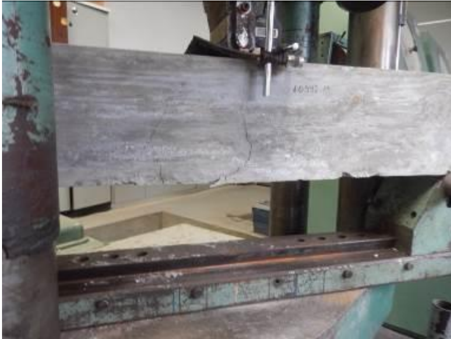
Figura 7 – Fissuras – Carregamento 4800 kgf – Amostra 1.0592.19
