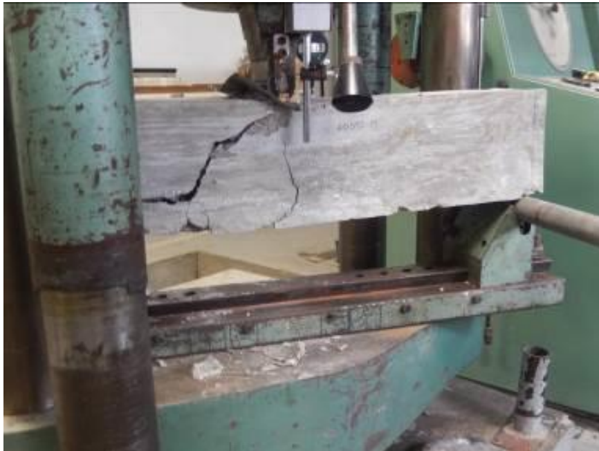
Figura 8 – Fissuras – Carregamento 6400 kgf – Amostra 1.0592.19
