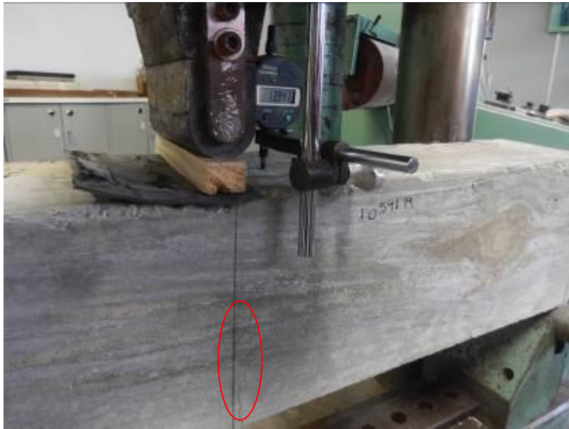
Figura 3 – Fissuras – Carregamento 2000 kgf – Amostra 1.0591.19
